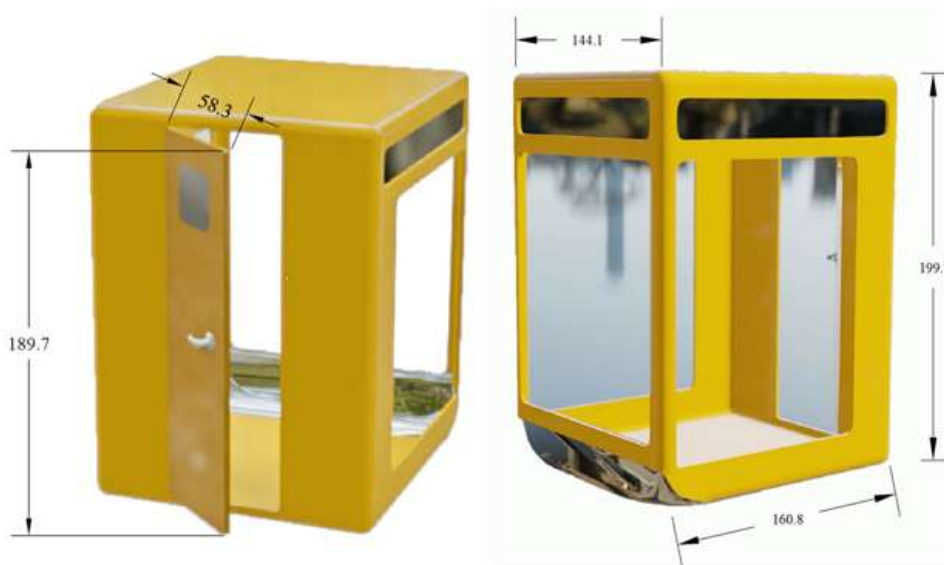
شکل ۴. نمای کلی و ابعاد اتاقک جرثقیل برجی طراحی شده براساس خروجی نرم افزار مدل سازی سه بعدی Blender
