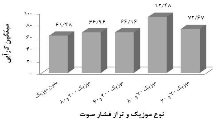
نمودار ۴: اثر نوع موزیک و تراز فشار صوت بر میانگین کارایی فیزیکی
