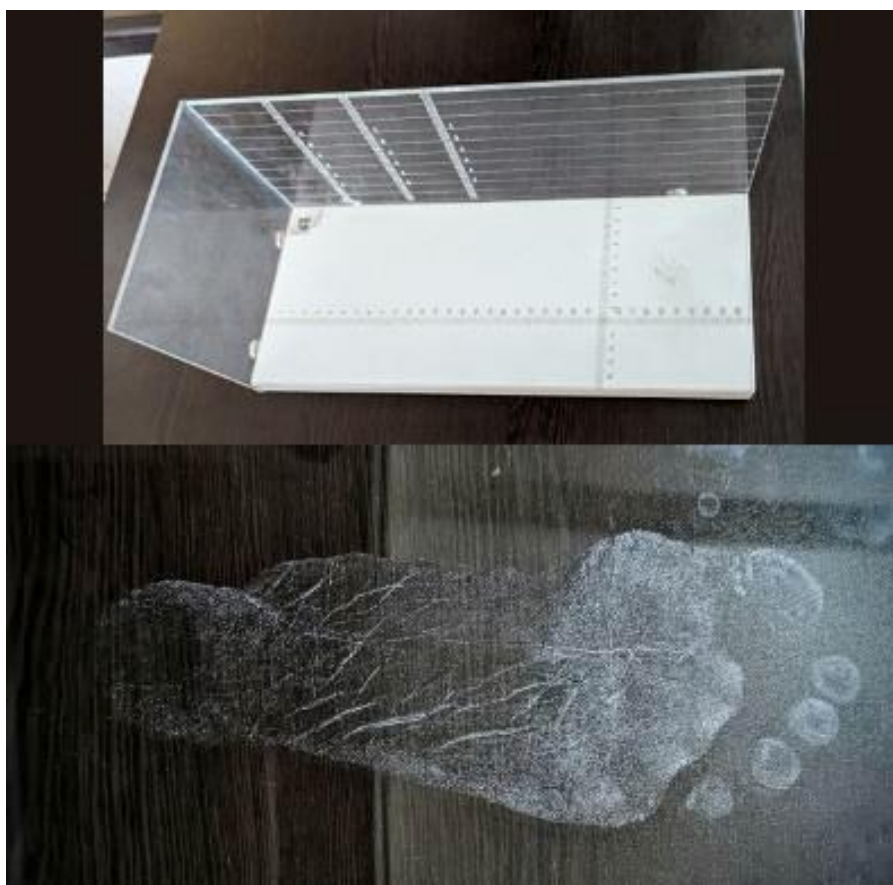
شکل ۲. وسیله اندازه‌گیری ابعاد پا و نمونه رد پای افتاده بر روی شیشه
