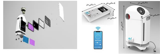
شکل ۱۷: ویژگی‌های عملکردی دستگاه تصفیه‌ی هوای نیک
