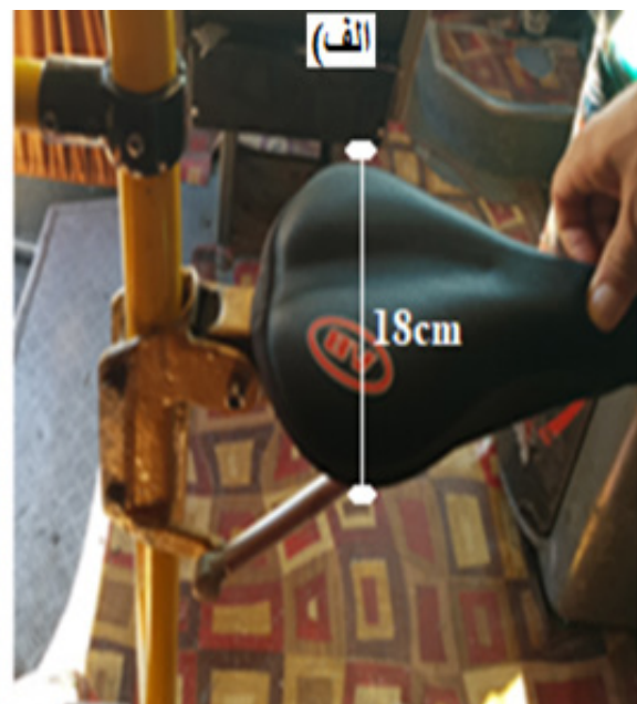
شکل ۱. صندلی ایستاده-نشسته، ویژه وسایل حمل‌ونقل عمومی درون‌شهری (الف: حالت باز شده - ب: حالت جمع شده)
