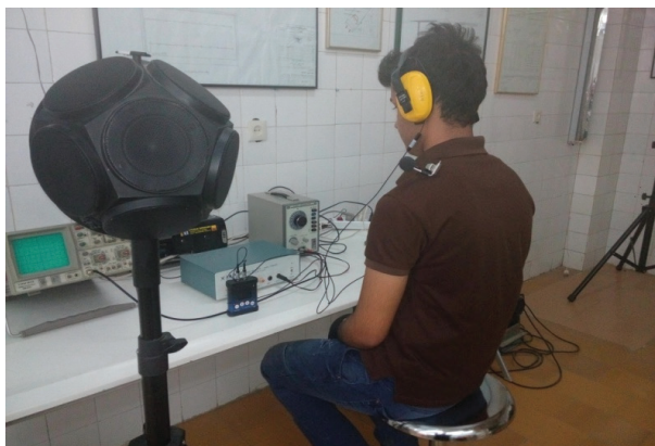
تصویر ۱: نحوه استقرار میکروفن های دزیمتر مدل SV102 در داخل و خارج گوش در حین آزمایش
